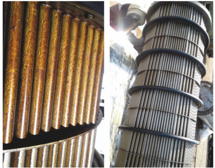
Wkład chłodnicy oleju „przed” i „po” czyszczeniu hydrodynamicznym
